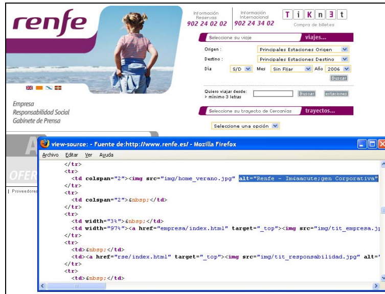
Imagen 4. La página de entrada al portal de RENFE es un ejemplo de aplicación correcta del uso de texto alternativo para las imágenes en las páginas Web.
